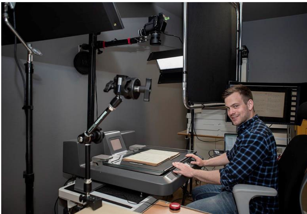
Digitaliseringsstasjon viser kameraoppsett og bruk av fastlys LED-lys. Operatør Håkon Wille ved IKAMR. Fotograf: Ottar A.B Anderson / IKAMR.
